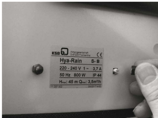
Abb. 12: Muttern am Klemmenkasten lösen
