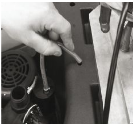
Abb. 19: Entlüftungsschlauch in den Nachspeisebehälter stecken
