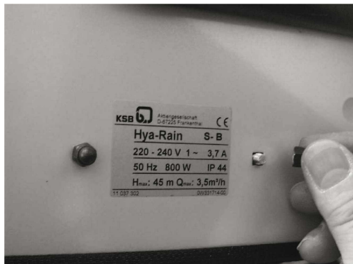
Abb. 15: Muttern am Klemmenkasten lösen
