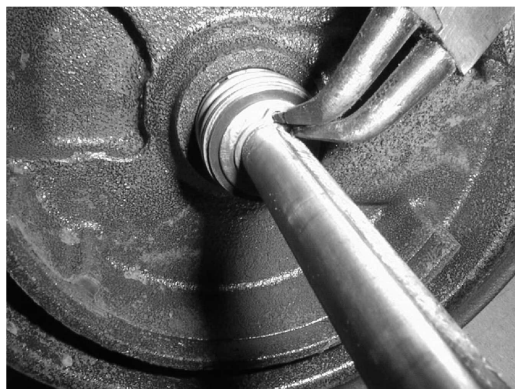
Abb. 35: Gleitringdichtung auf die Welle schieben
