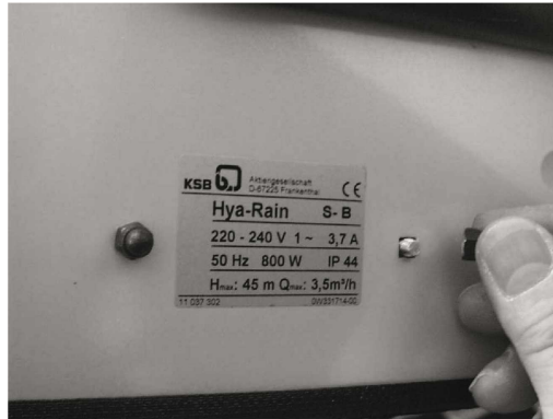
Abb. 8: Muttern am Klemmenkasten lösen
