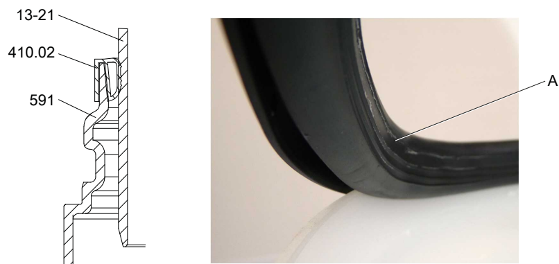
Abb. 13: Profildichtung in Einzelanlagen einbauen
